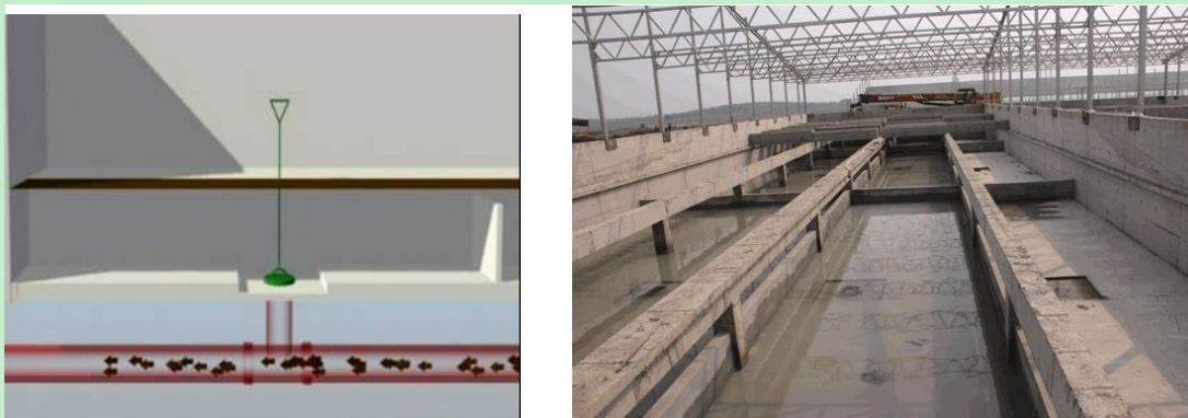
图 2.2-1 浅坑拔塞粪沟结构示意图
